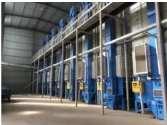
图 3 B 合作社的烘干机（12 台 15 吨）
